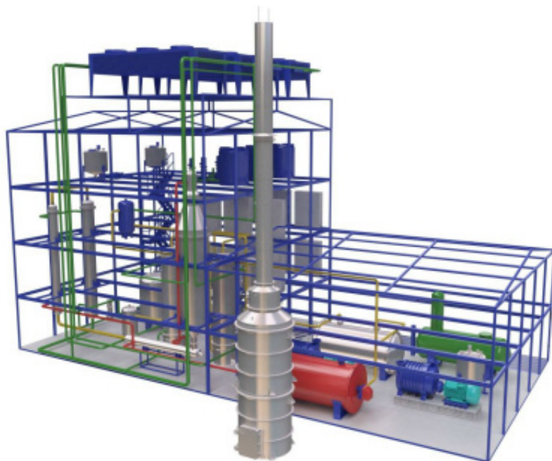
Рис. 2. Конструктивная 3D-схема блочно-модульного исполнения малотоннажной установки производства метанола
